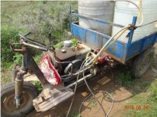
图 12-11 以柴油机作动力的三联泵喷雾设备
